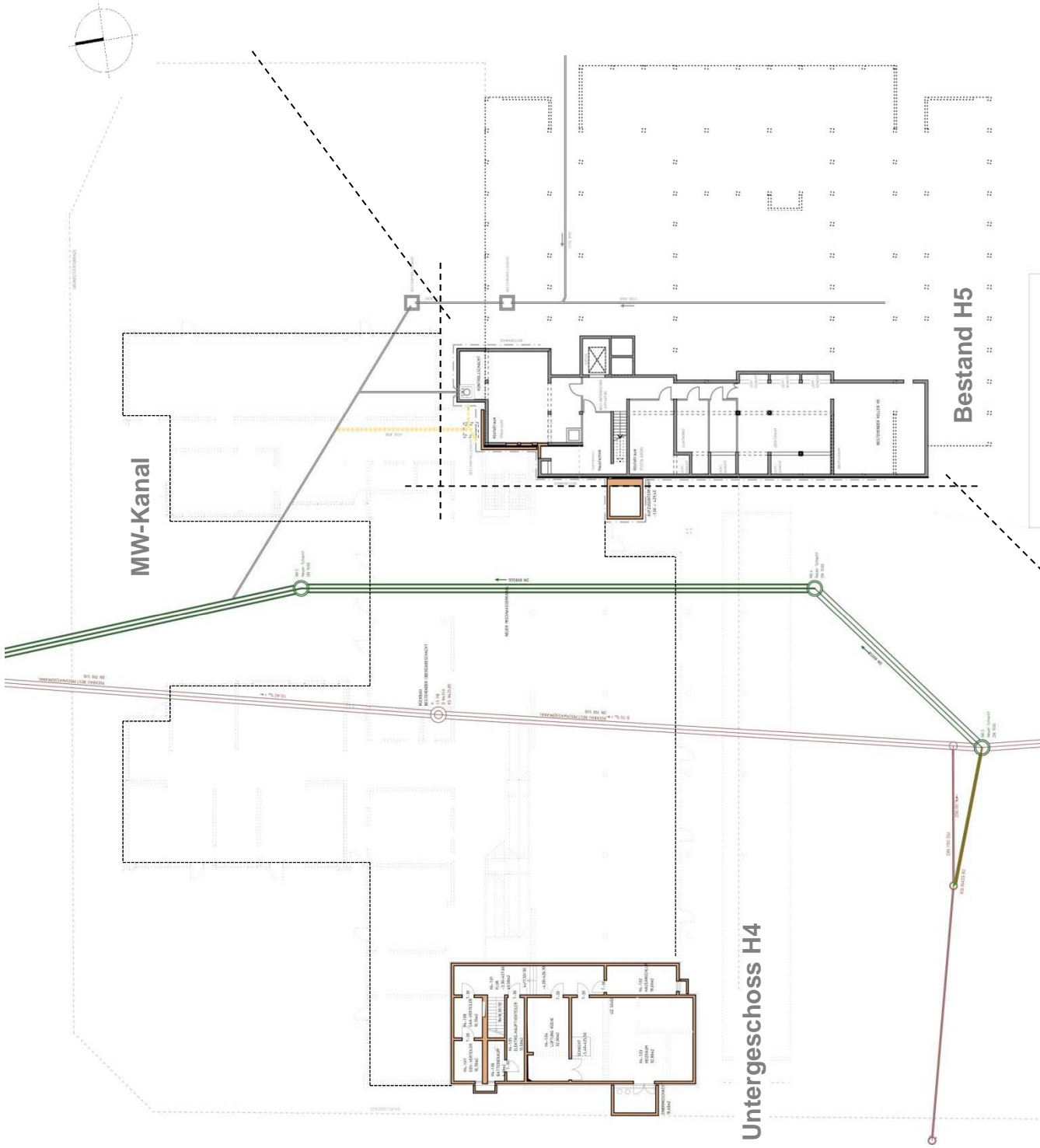
Maßnahme MW-Kanal / Untergeschoss H4 (Heizzentrale)
