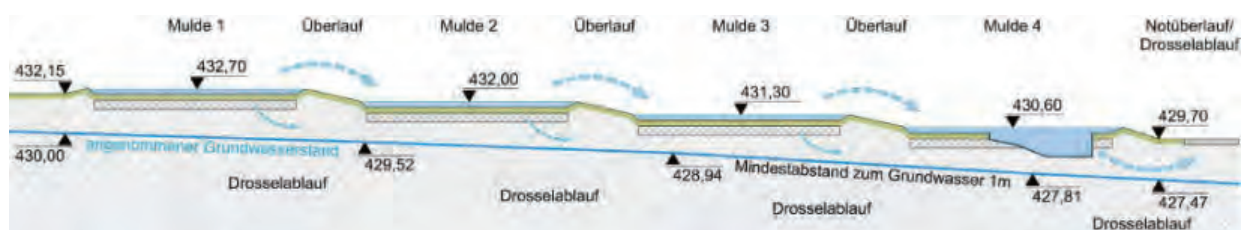
Schematischer Schnitt Szenario 4 - Mulden-Rigolen-Systems mit Stillgewässer
