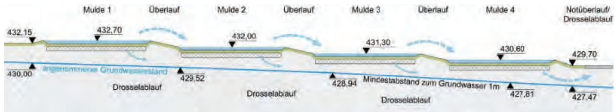
Schematischer Schnitt Szenario 3C - Aufbau eines Mulden-Rigolen-Systems mit künstlichen Elementen
