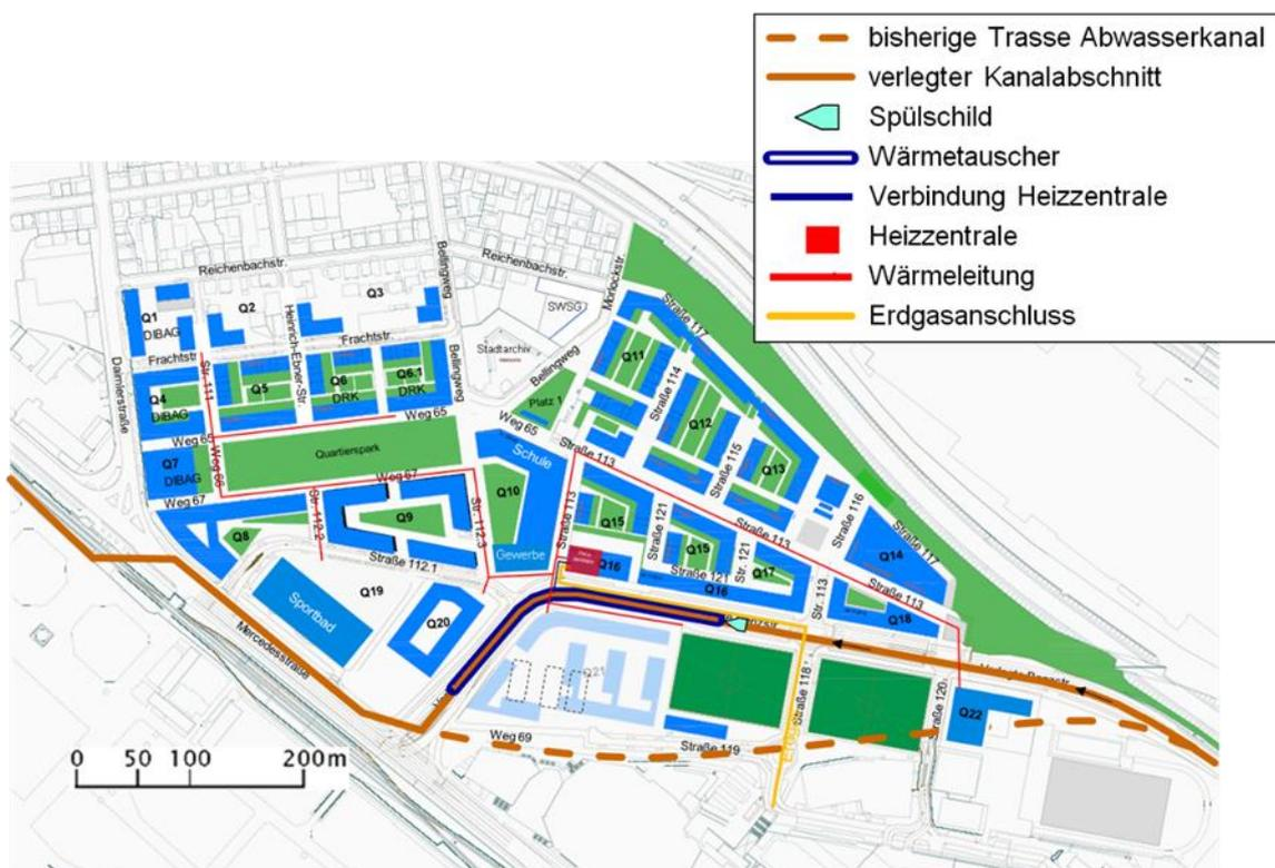
Bild 55 Neckarpark Stuttgart – Versorgung mit Wärme aus Abwasser
