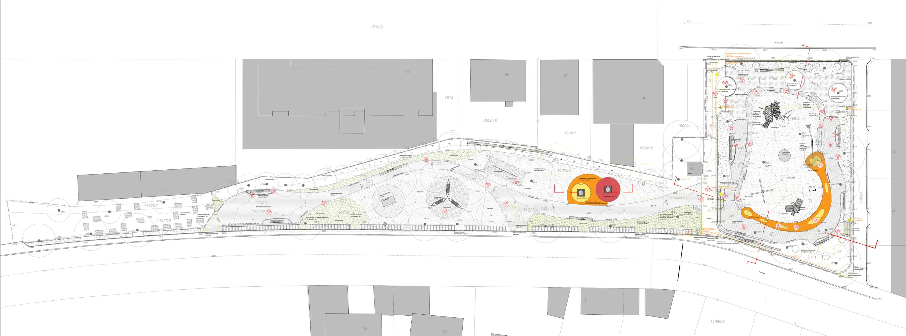
Alle Baumscheiben in Belagsflächen aus Wassergebundene Decke, 2-schichtig, Handeinbau, mit Kleingerät statisch verdichten. Tragschichten in Abstimmung mit Bauleitung Durchmesser Baumscheiben - 4m.
