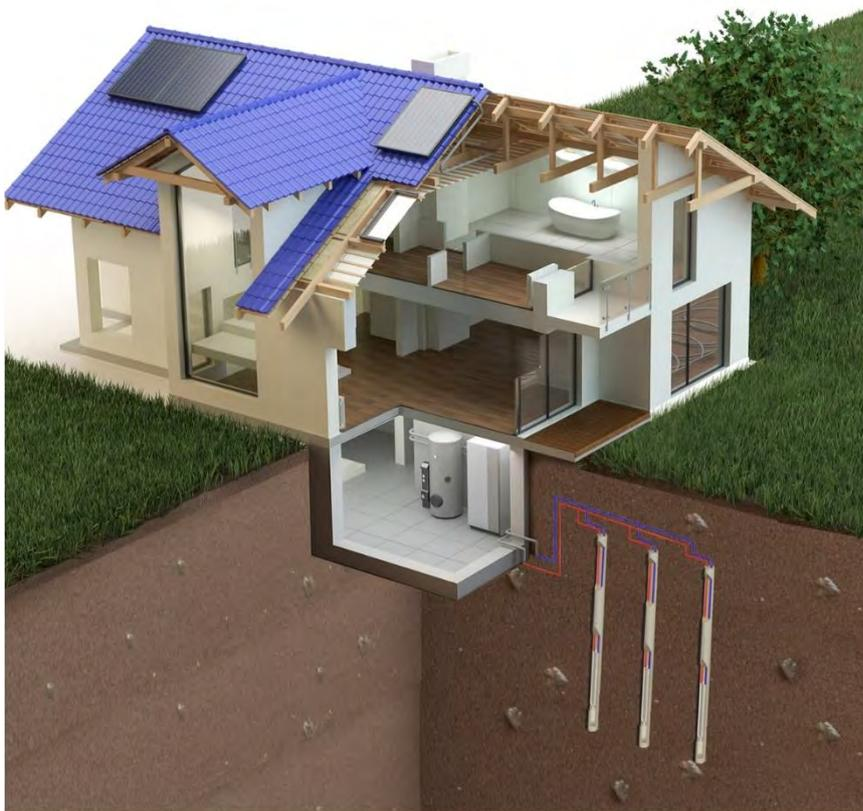
**Bild 25** Geothermie-Wärmepumpe in Wohngebäude (Bild: KangeStudio@istockphoto.com, bearbeitet: LHS)
