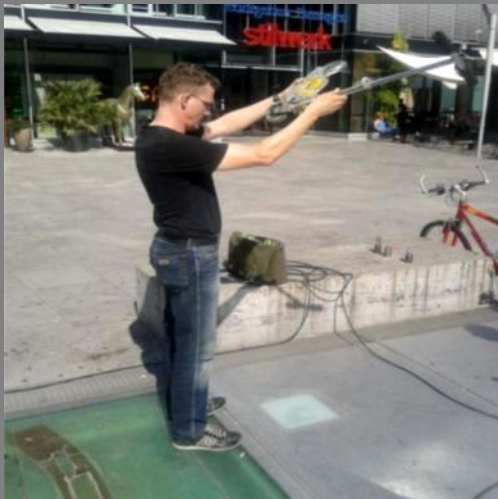
Sanierung Oberlichtband Kunstmuseum - Belastungstests Fallversuche zum Materialverhalten auf Dauerhaftigkeit
