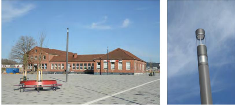
Abbildung 5.2: Beleuchtung auf dem Marga-von-Etzdorf-Platz im Neckarpark. Neben Stelen mit integrierten Marktstromanschlüssen wurden auch Piano Leuchten auf lackierten Masten verbaut.
