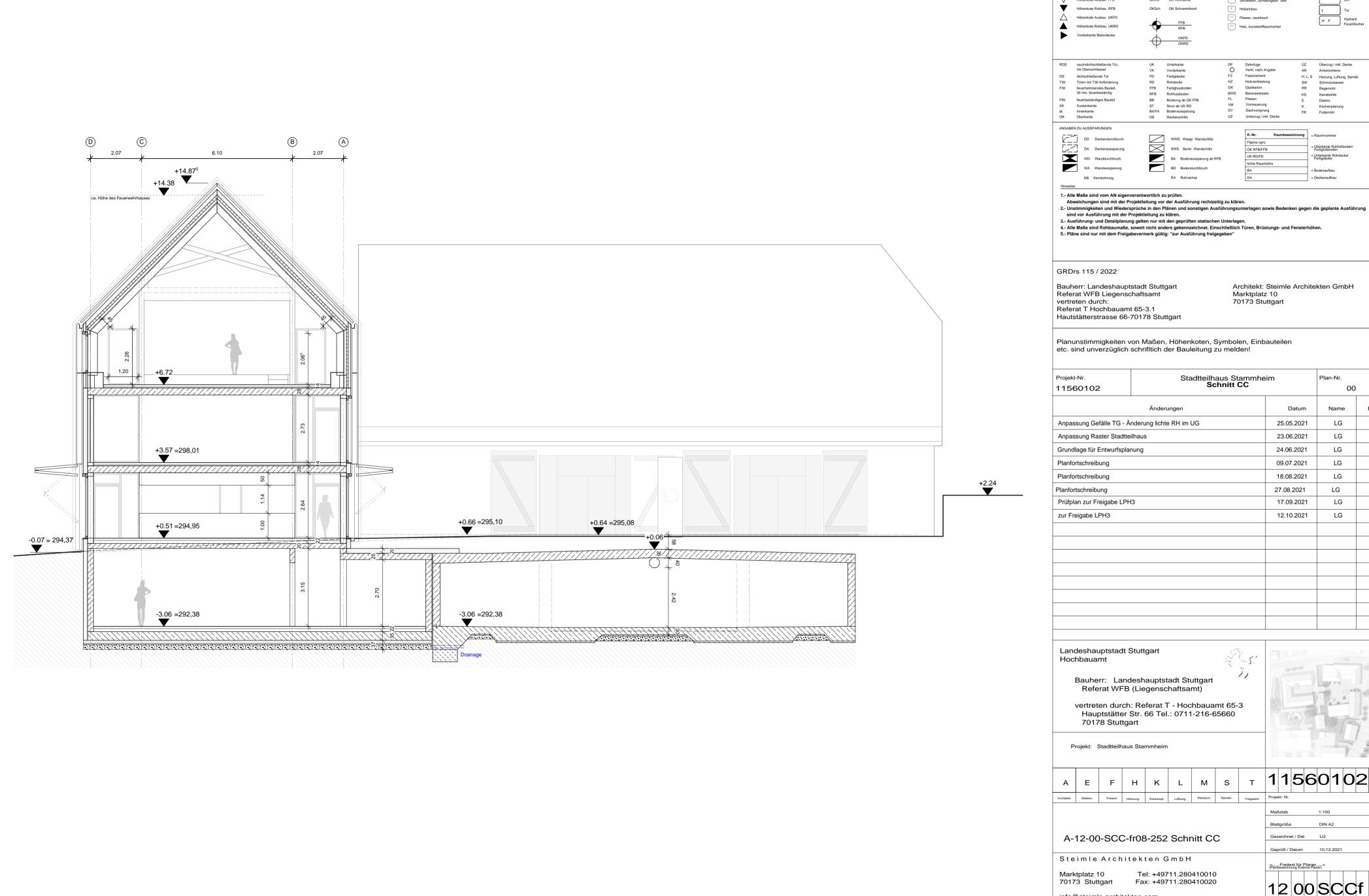
LEGENDE: Stahlbeton Dämmung weich Beton unbewehrt WU-Beton Massivholzwand Dämmung hart Holz, tragend Glasschaumschotter Glaswand Bauteile über horizontaler Schnittebene Unsichtbare Kanten von Bauteilen ZEICHENERKLÄRUNG SCHNITTSYMBOLE WANDOBERFLÄCHE
