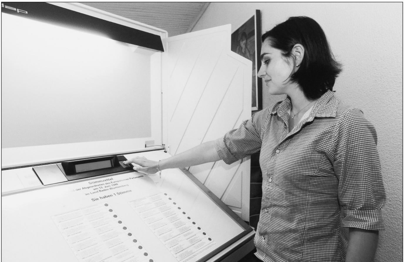
Bild: Stimmabgabe mit dem elektronischen Wahlgerät (Bild: Frank Eppler)
