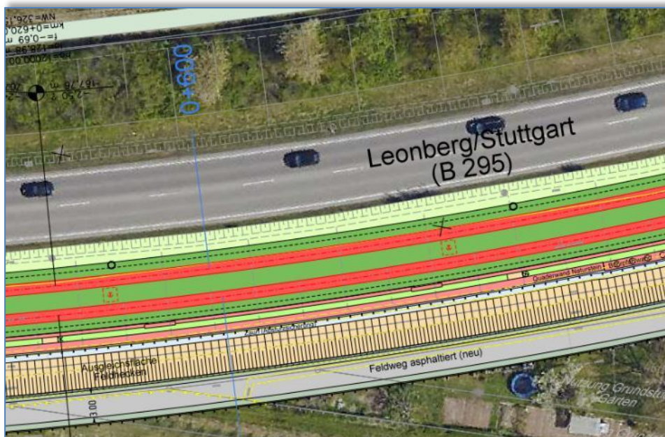
Aufbau der Trasse entlang der B295 mit Stützwand, begrünter Böschung und Feldweg
