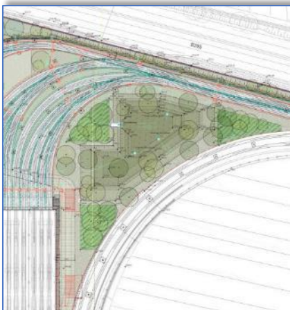
Regenrückhaltung bei Gleisharfe
