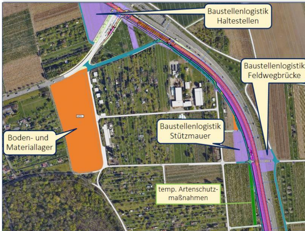
Bauzeitliche Flächeninanspruchnahme Bereich B295 nordost
