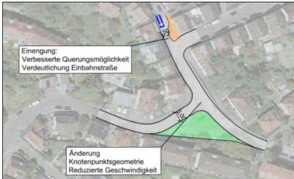
Die bauliche Einengung im Bereich der Einmündung der Hummelbergstraße in die Vaihinger Landstraße, einschließlich Änderung der Eckausrundung, führt zu einer Hervorhebung der Einbahnstraßensituation und Reduzierung der Falschfahrer.
