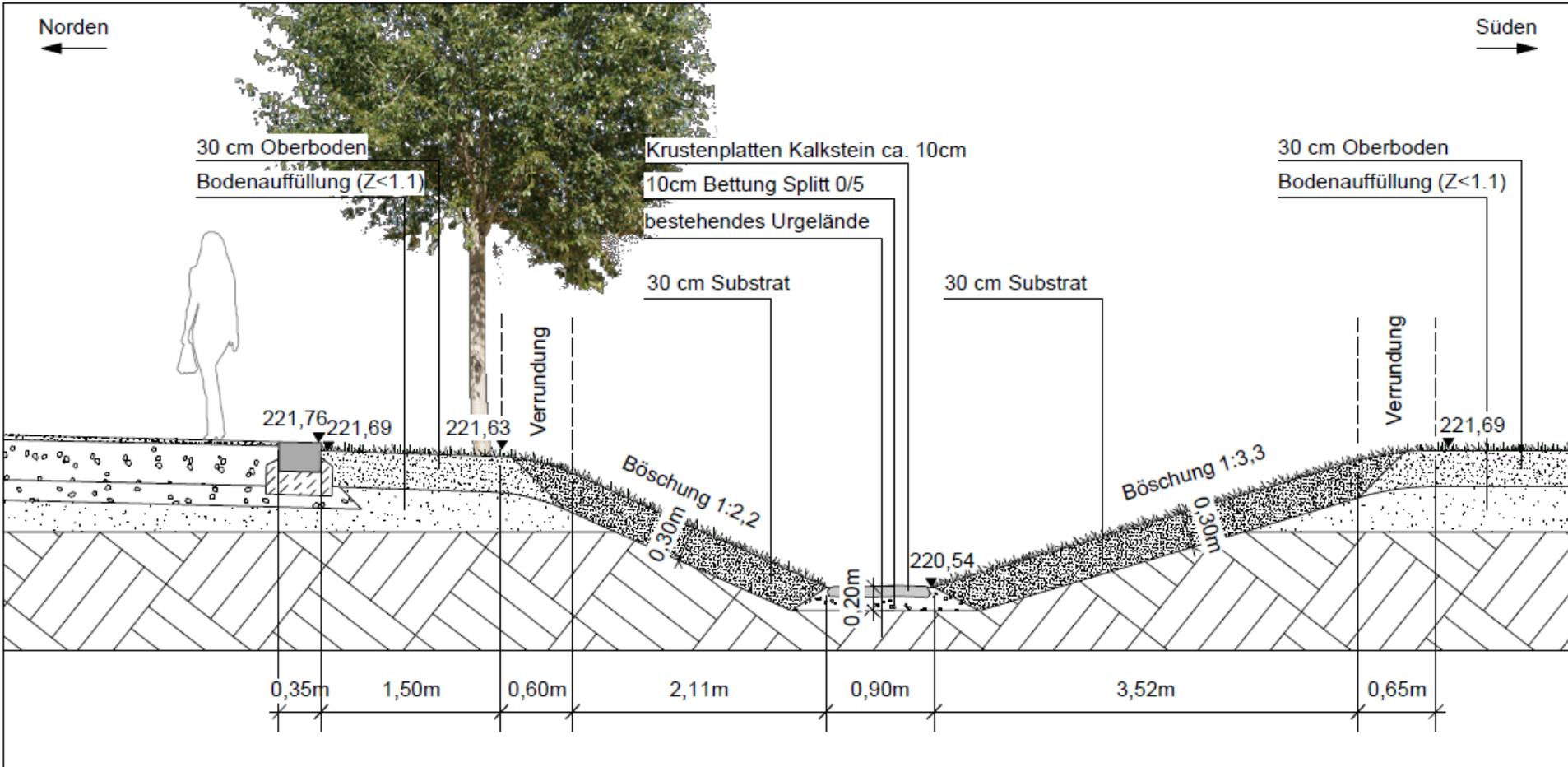
Versickerungsgraben Querschnitt Ost M 1:50
